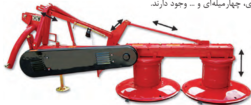
شکل ۴- مکانیزم میله‌ای در دروگر
