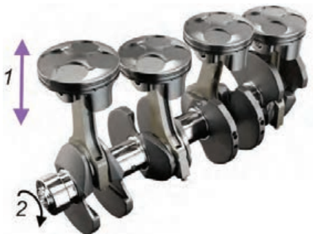
شکل ۱۹- کاربرد مکانیزم لنگ و لغزنده در موتور
