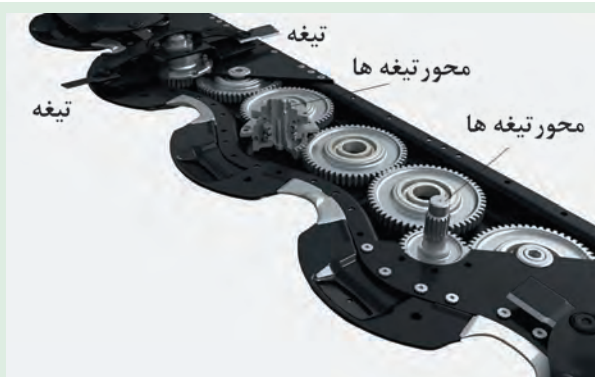
شکل ۵۱ - چرخ دنده‌های محرک تایغه‌ها در دروگر بشقابی
