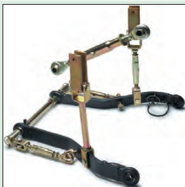
شکل ۶- میله‌ها و مفصل‌های اتصال سه نقطه تراکتور
