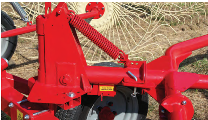
شکل ۱۵- مکانیزم شناوری شانه خورشیدی
