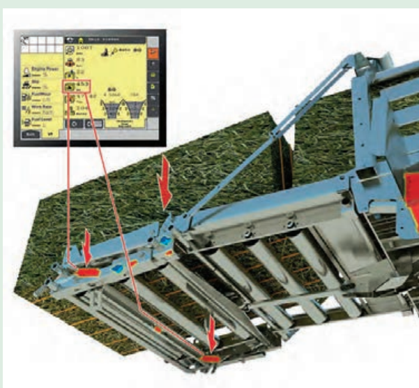
شکل ۴۹- کاربرد لودسل در بسته بند مکعبی
