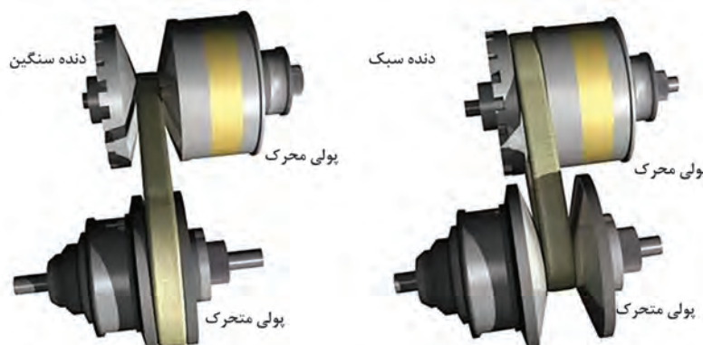
شکل ۶۲- نحوه عملکرد پولی‌های با قطر متغیر
